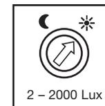
Stufenlos einstellbare Ansprechschwelle des Sensors von 2 – 2000 Lux.
